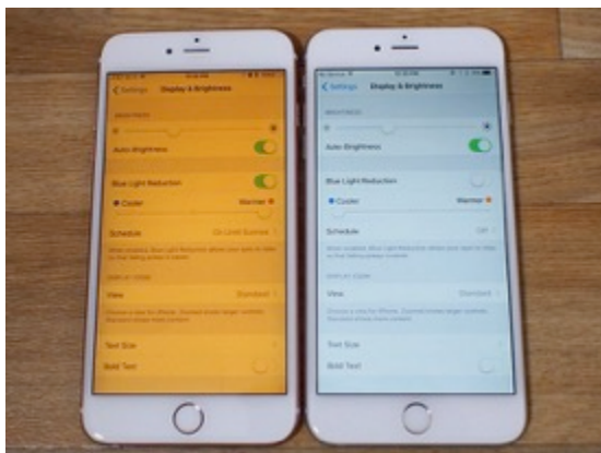
Obr. 23. Ilustrační fotografie znázorňující rozdíl v barevném vyzařování displeje s aktivním (vlevo) a neaktivním programem f.lux.
